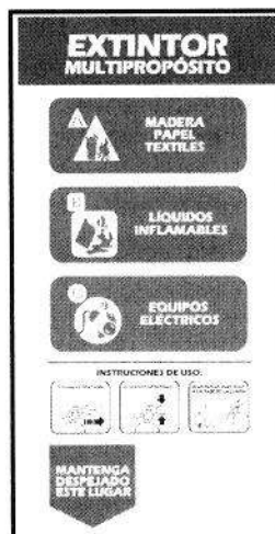
Ilustración 10. Ejemplo de rotulación de extintores
